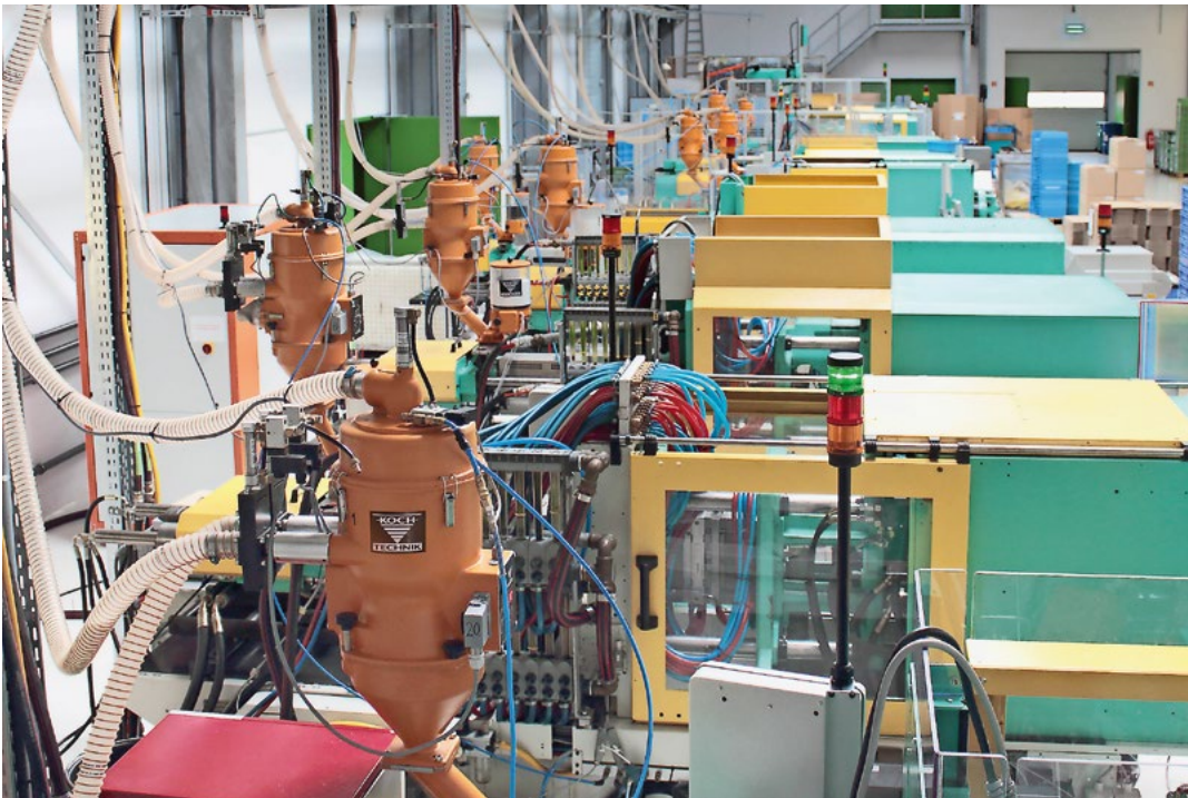
Spritzgießlinie mit Koch-Technik Förderabscheidern auf den Spritzgießmaschinen in Werk 2 in Dohma. Über die Materialleitungen wird das Rohmaterial angesaugt und im Abscheider von der transportierenden Luft getrennt. Foto: Koch-Technik
