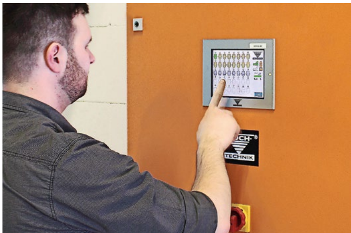
Die Materialversorgung für die Spritzgießmaschinen und die Trocknungsanlage lässt sich auf dem Touchpanel der SPS S7-Steuerung überwachen und anpassen. Foto: Koch-Technik
