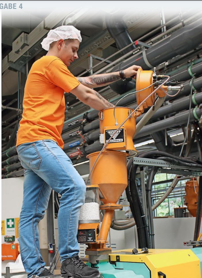
Die Koch-Geräte sind modular aufgebaut und können in einem Baukastensystem zusammengestellt werden. Die Förderhauben lassen sich klappen und der Förderkörper seitlich wegschwenken – direkt auf der Maschine und völlig ohne Werkzeug. Foto: Koch-Technik
